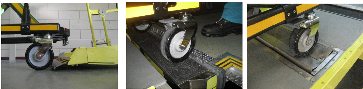
Afbeelding 3a, 3b en 3c. De drie drempeltjes waarover de Engels-Drentse brancard wordt geduwd bij het inrijden van het voertuig. In deze studie is alleen het meest linker drempeltje onderzocht (a). Gaandeweg het ontwikkelproces van de brancard zijn de beide andere drempels geïntroduceerd (afbeeldingen b en c). Deze zijn niet beoordeeld.
